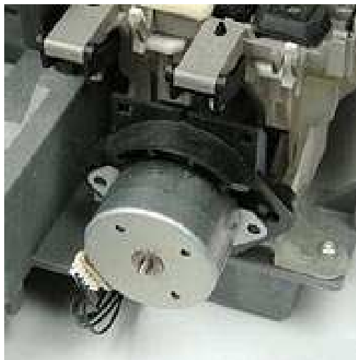
Slika 4 Mehanizam za transport glave Ink-Jet štampača
